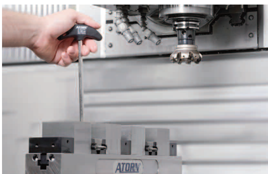
konventionell Maschinen-Stillstandzeit: Rüsten in der Maschine
