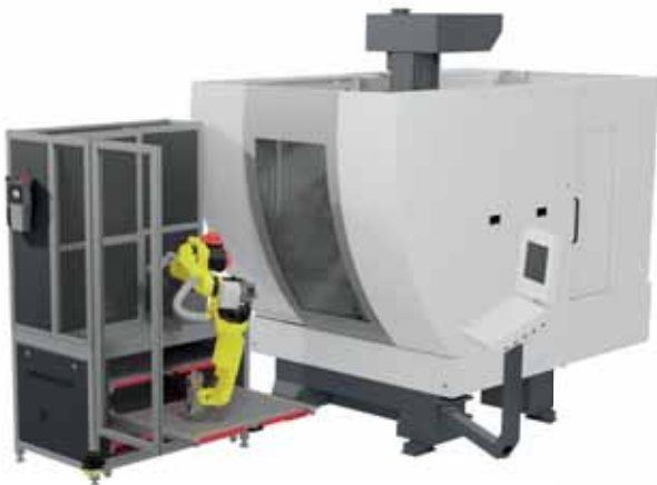
ROBOTCEL UIT DE RZS-SERIE GEMONTEERD AAN DE VOORZIJDE VAN DE MACHINE.
