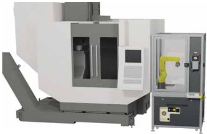
ROBOTCEL AAN DE ZIJKANT VAN EEN MACHINE GEMONTEERD.
