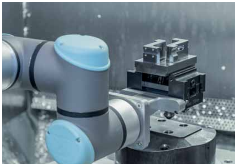
... legt ze in de gereedschapsmachine, haalt de bewerkte onderdelen eruit en plaatst ze terug.
